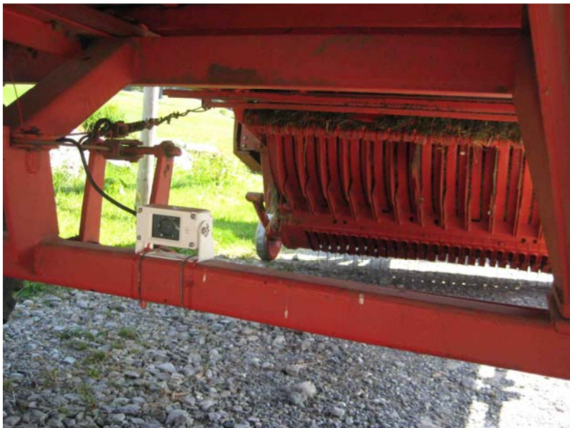
Die Rückfahrkamera wurde auf die Hinterachse des Ladewagens montiert, dadurch wird der Bereich ab der Hinterachse einsehbar.
