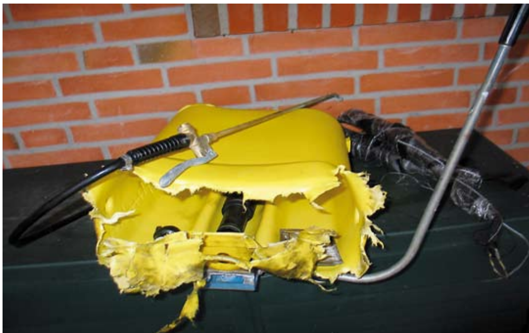
Explodierte Rückenspritze mit herausgerissenem Boden
