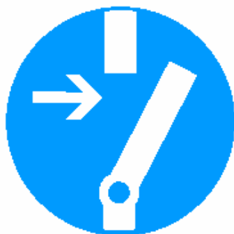
M014 Vor Arbeiten freischalten
