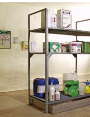
◀ Abb. 3: Regal mit Auffangwanne
