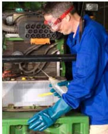
PSA bei der Batteriewartung
