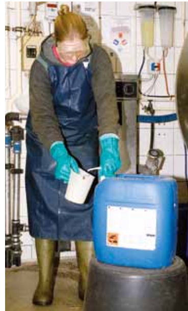
PSA bei der manuellen Dosierung von MMR
