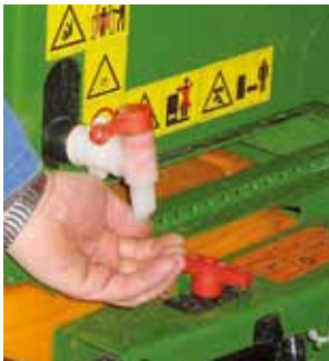
Frischwasserbehälter an PSM-Gerät
