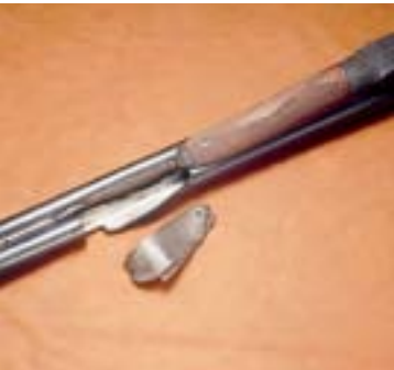
Laufsprengung als Folge einer nicht funktionssicheren Waffe
