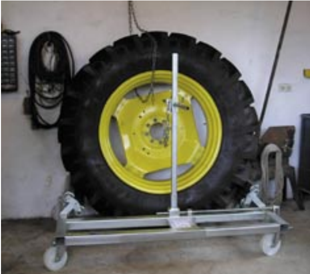
Schlepperreifen gegen Fortrollen und Umfallen sichern (hier: Montagewagen und Kette).
