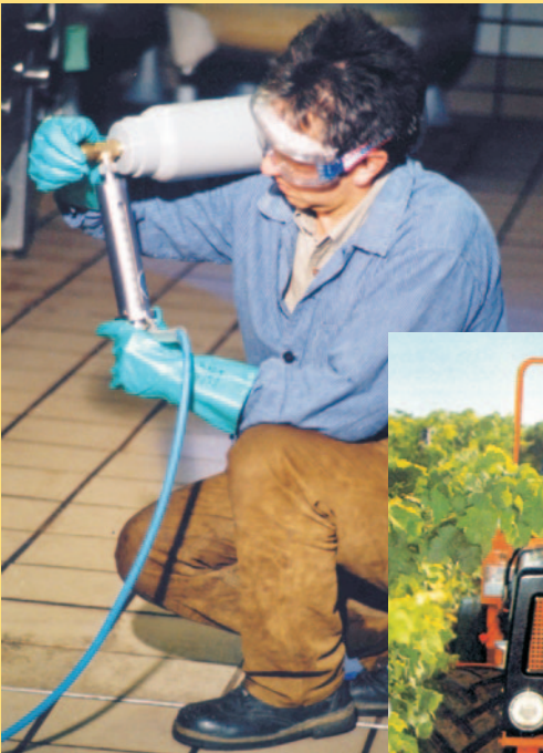
Schwefeldioxiddosierung mit Schutzbrille
