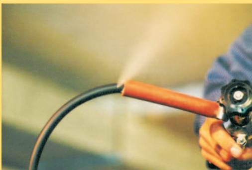
Leckage eines ungeeigneten, nicht druck- und säurefesten Schlauches zur Dosierung von SO 2
