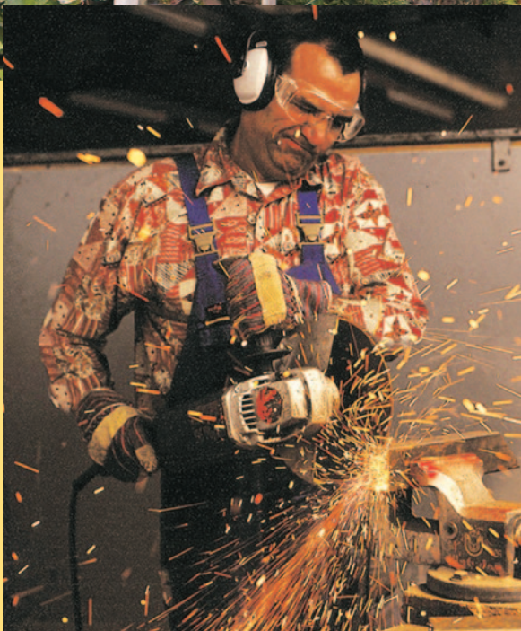
Schutzbrille und Gehör- schutz beim Arbeiten mit dem Trennschleifer
