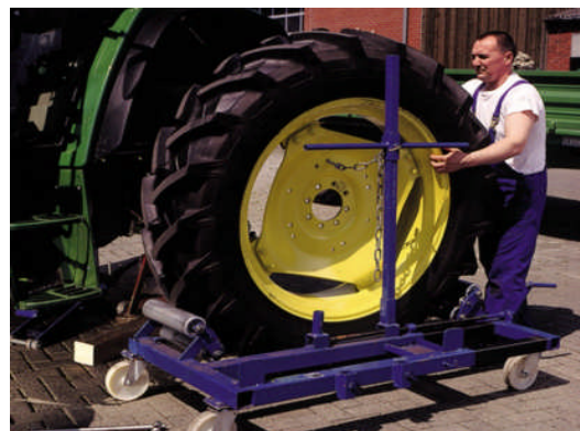
Montagevorrichtung zum sicheren Reifenwechsel
