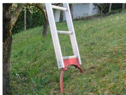
Bei Bodenunebenheiten Leitern mit Niveaueingleich einsetzen
